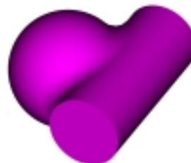
Ejemplo: Adición entre una esfera y un cilindro con condición de transición tangente a las superficies iniciales.
